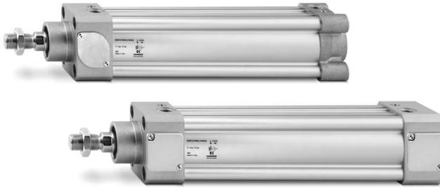
Los cilindros neumáticos Serie 63 están equipados con bloqueos mecánicos automáticos de final de carrera que garantizan la sujeción segura del vástago del cilindro, tanto en la posición completamente retraída como en la completamente extendida. Los bloqueos se activan y liberan automáticamente, sin necesidad de señales o comandos externos. El cilindro con bloqueo al final de carrera Serie 63 cumple con la norma ISO 15552.
